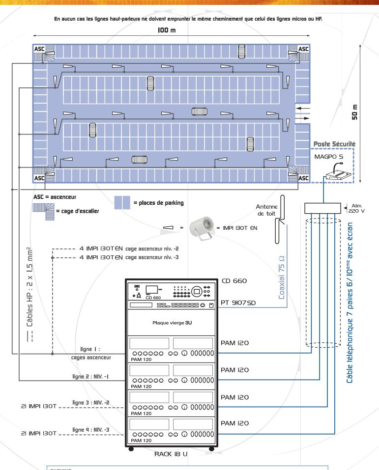
**PARKING**: IMPI 130T EN câblés en 4 W x 2I = 84 W de charge pour une puissance d'ampli de 120 W et ce à chaque niveau. **CAGES ASCENCEUR**: IMPI 130T EN câblés en 4 W x 4 = 16 W x 3 niveaux = 48 W de charge pour une puissance d'ampli de 60 W.
